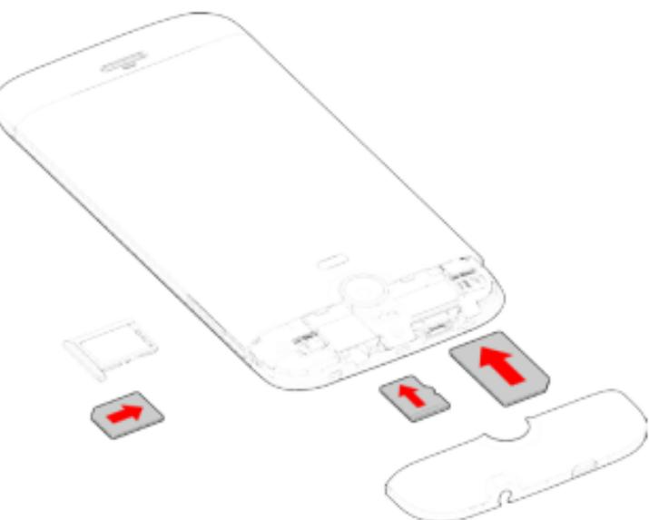
Inserire correttamente la scheda SIM standard nell'alloggiamento a sinistra.
