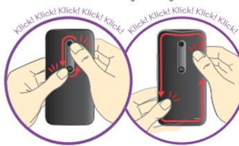
**Achtung:** Verwenden Sie keine Werkzeuge, um die Abdeckung zu entfernen, da dies zu Schäden am Telefon führen könnte.
