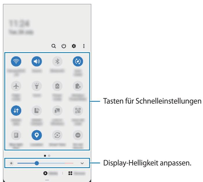
Tippen Sie den Text unter den Schaltflächen an, um Funktionseinstellungen zu ändern. Sie können detailliertere Einstellungen aufrufen, indem Sie eine Taste berühren und halten.
