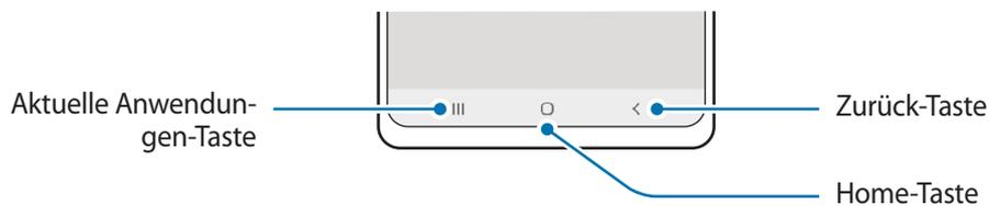
Wenn Sie das Display einschalten, werden unten auf dem Bildschirm die Softkeys angezeigt. Weitere Informationen finden Sie unter [Navigationsleiste \(Softkeys\)](#).
