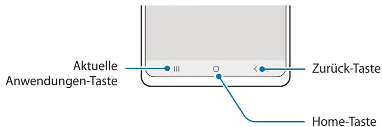
Wenn Sie das Display einschalten, werden unten auf dem Bildschirm die Softkeys angezeigt. Weitere Informationen finden Sie unter [Navigationsleiste \(Softkeys\)](#).
